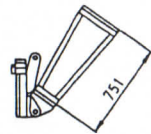
Outrigger 5 AK with balance rod 5 / Parallel Mechanism foldable, short Ausleger 5 AK mit Zugstange 5 / Parallellführung klappbar, kurz Weight: 41,2 kg Art.Nr.: 109145
